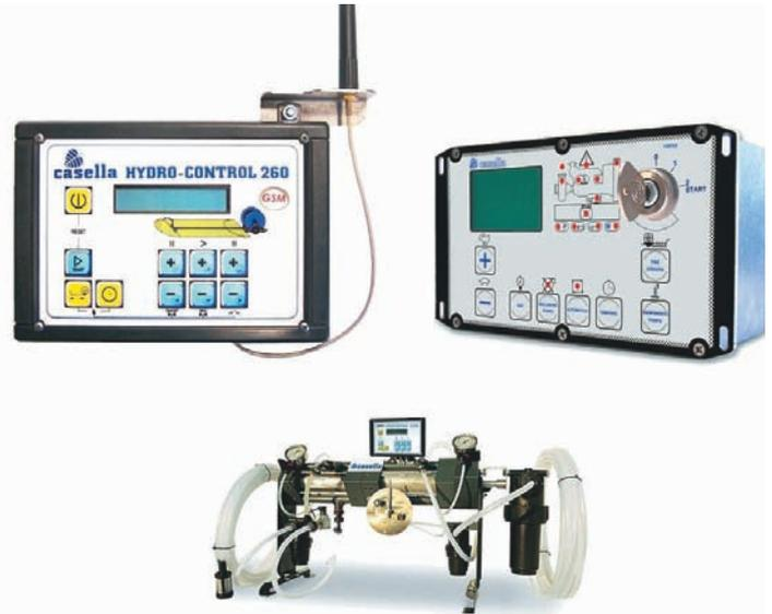
Le centraline montate sugli irrigatori a naspo consentono la completa automazione dell'esercizio irriguo (in alto a sinistra), comprese la gestione della motopompa (in alto a destra) e della fertirrigazione (in basso)
