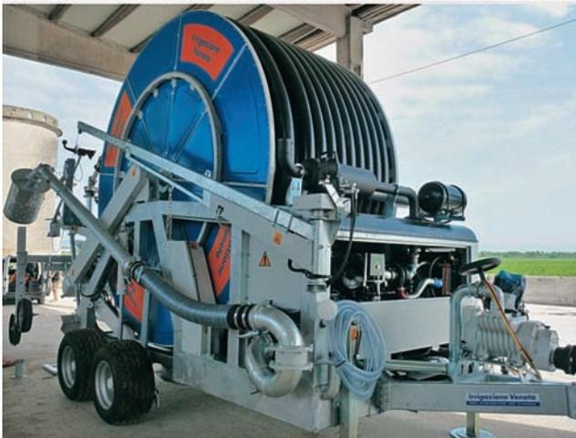
Due versioni di irrigatore a naspo, senza (sopra) e con motopompa (sotto)
