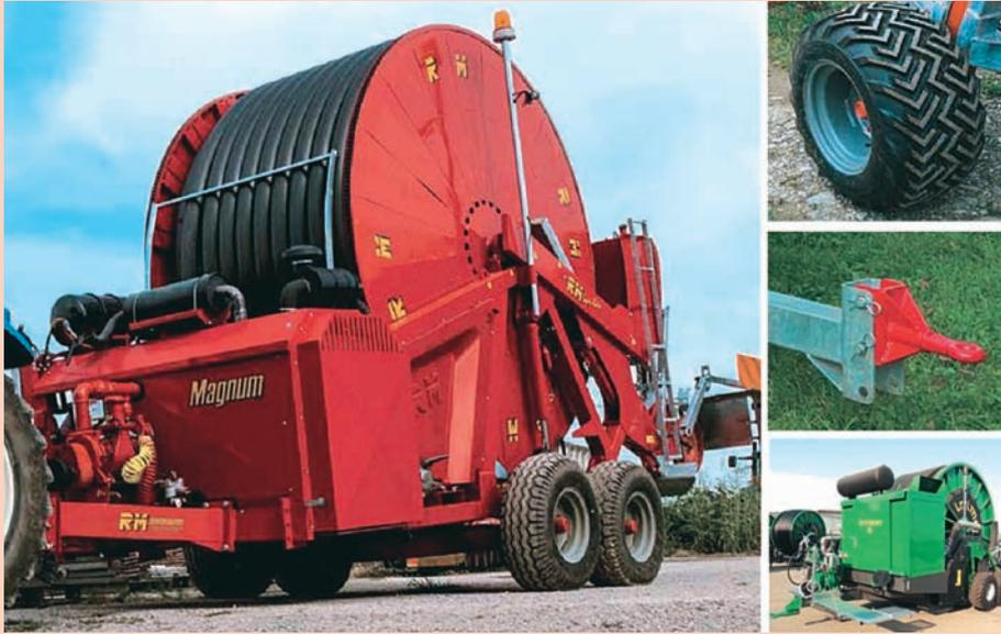
Alcune delle più moderne dotazioni degli irrigatori a nastro: l'assale a bilanciare asimmetrico (a sinistra), pneumatici a sezione larga, occhione ad altezza regolabile e motopompa insonorizzata (a destra, dall'alto in basso)
